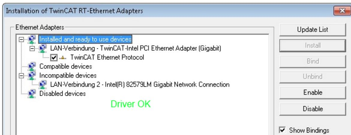
Abb. 31: Beispielhafte korrekte Treiber-Einstellung des Ethernet Ports
