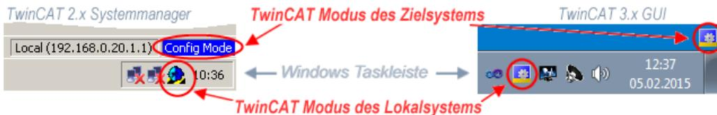
Abb. 96: Unterscheidung Lokalsystem/ Zielsystem (links: TwinCAT 2; rechts: TwinCAT 3)
