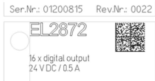
Abb. 1: EL2872 mit Revision 0022 und Seriennummer 01200815
