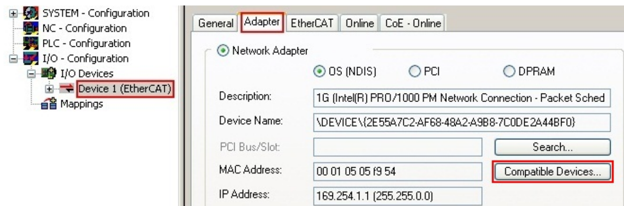
附图 103: EtherCAT 设备属性（TwinCAT 2）：点击“Adapter”选项卡的“Compatible Devices...”
