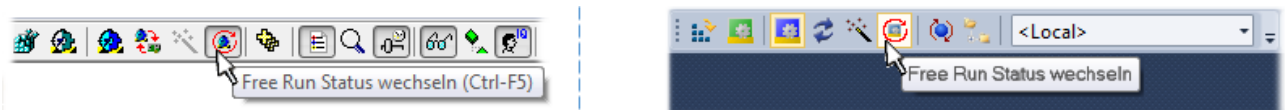
Abb. 73: TwinCAT kann auch über einen Button in diesen Zustand versetzt werden (links: TC2; rechts TC3)
