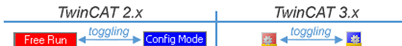
Abb. 101: Anzeige des Wechsels zwischen „Free Run“ und „Config Mode“ unten rechts in der Statusleiste
