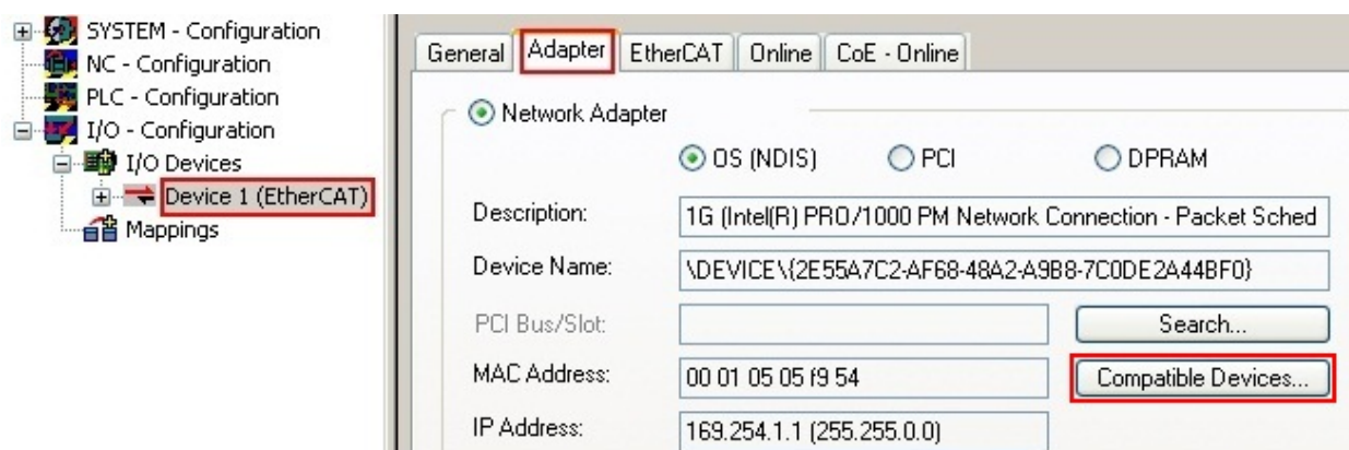
附图 68: EtherCAT 设备属性 (TwinCAT 2)：点击“Adapter”选项卡的“Compatible Devices...”
