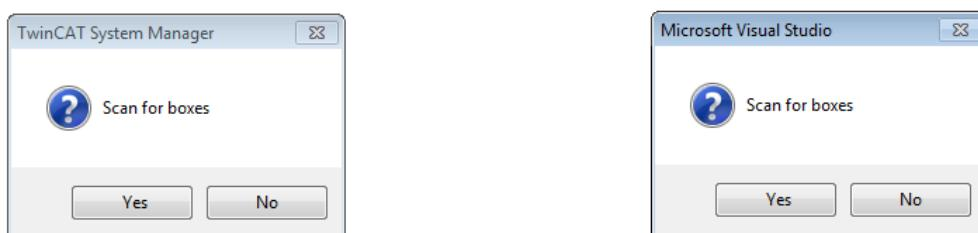
附图 124: 自动创建 EtherCAT 设备后的扫描（左：TwinCAT 2；右：TwinCAT 3）
