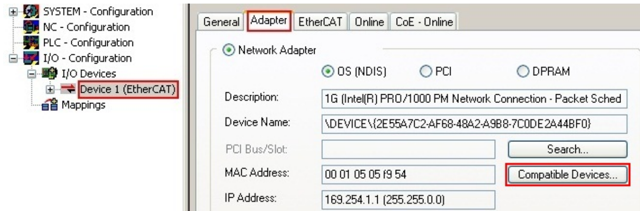
附图 69: EtherCAT 设备属性（TwinCAT 2）：点击“Adapter”选项卡的“Compatible Devices...”
