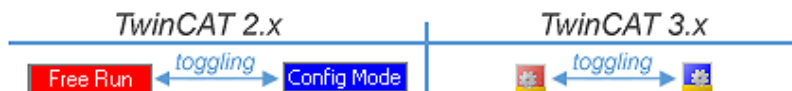
Abb. 103: Anzeige des Wechsels zwischen „Free Run“ und „Config Mode“ unten rechts in der Statusleiste
