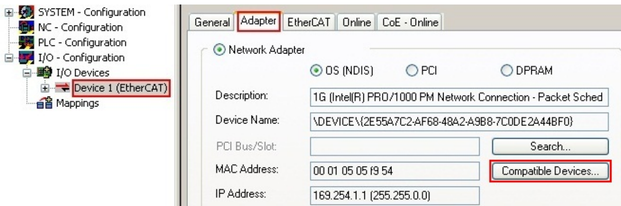
附图 47: EtherCAT 设备属性 (TwinCAT 2)：点击“Adapter”选项卡的“Compatible Devices...”
