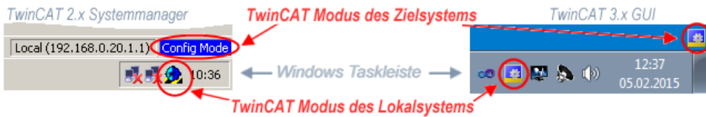
Abb. 68: Unterscheidung Lokalsystem/ Zielsystem (links: TwinCAT 2; rechts: TwinCAT 3)
