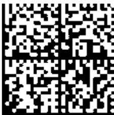
Abb. 5: Beispiel-DMC **1P**072222**S**BTNk4p562d7**1K**EL1809 **Q**1 **51S**678294
