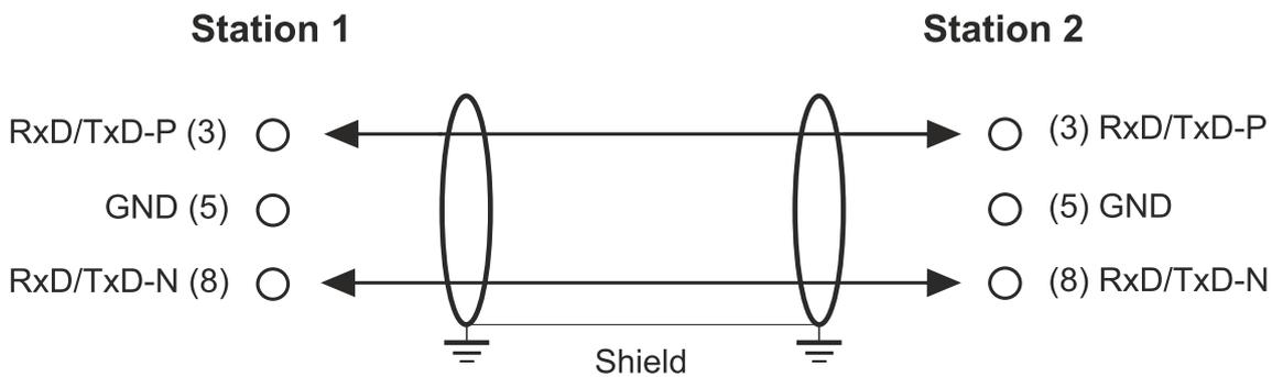
Fig. 13: PROFIBUS cabling
