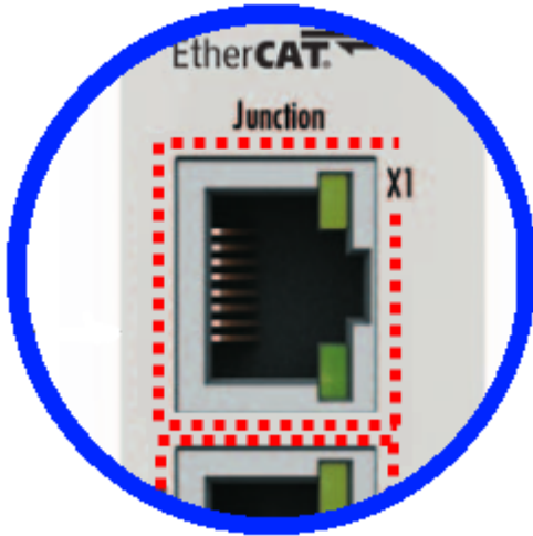
附图 6: EK1122-0080 和 EK1101-0080 的 FHC 端口的识别
