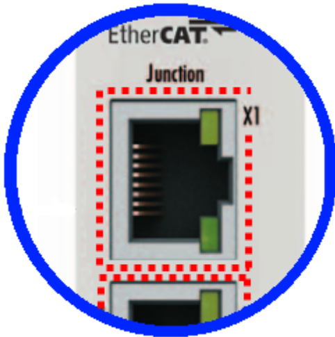
附图 6: EK1122-0080 和 EK1101-0080 的 FHC 端口的识别
