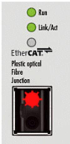
Abbildung: Transmitterkanal beim EK1561
