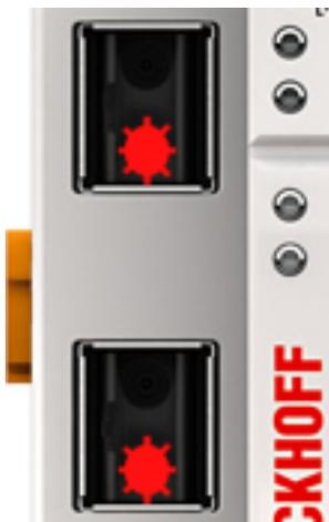
Abbildung: Transmitterkanäle beim EK1541
