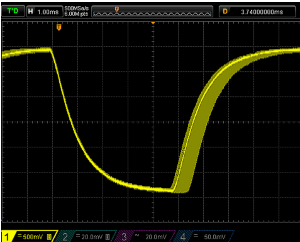
Abb. 28: EL4078 mit 100 µs EtherCAT Zykluszeit, Ausgabejitter > 1 ms
