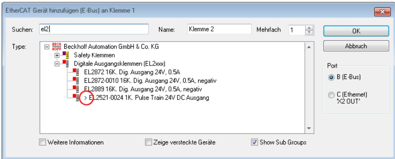
Abb. 96: Kennzeichnung einer online erfassten ESI am Beispiel EL2521
