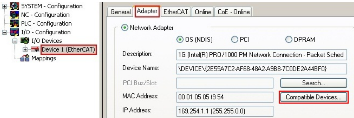
附图 66: EtherCAT设备属性 (TwinCAT 2) : 点击“适配器”选项卡的“兼容设备...”
