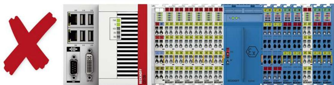
附图 12: 不允许的安装 - ELX 端子模块网段中的端子模块不属于 ELX 系列
