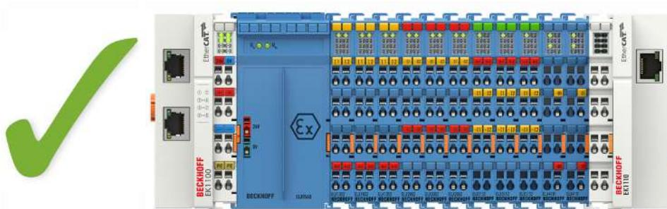
附图 8: 允许的安装 - 不属于 ELX 系列的端子模块被放置在 ELX 端子模块网段的前后。由 ELX 端子模块网段开头的 ELX9560 和 ELX 端子模块网段末端的 EK1110 隔离。
