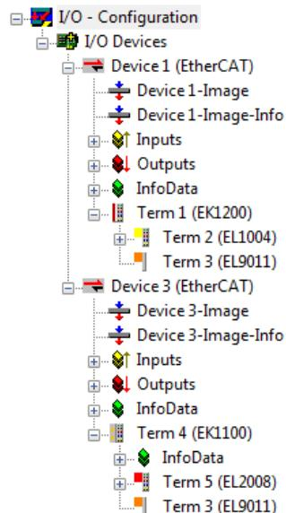
附图 39: TwinCAT 2系统管理器中的配置映射
