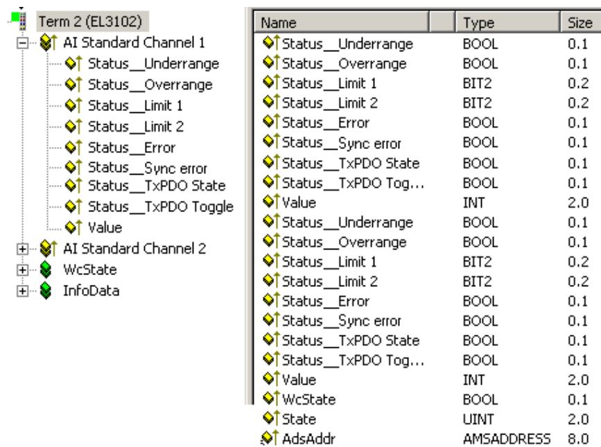
附图 149: TwinCAT 2.10下以元素为导向的过程图像
