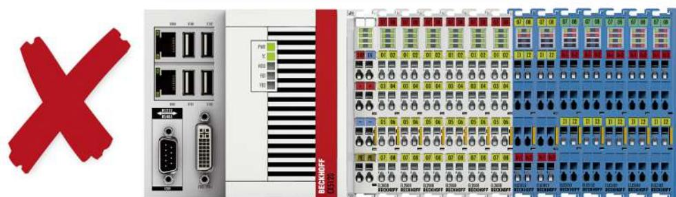
附图 11: 非法的安装 - 缺少 ELX9560 电源端子模块。
