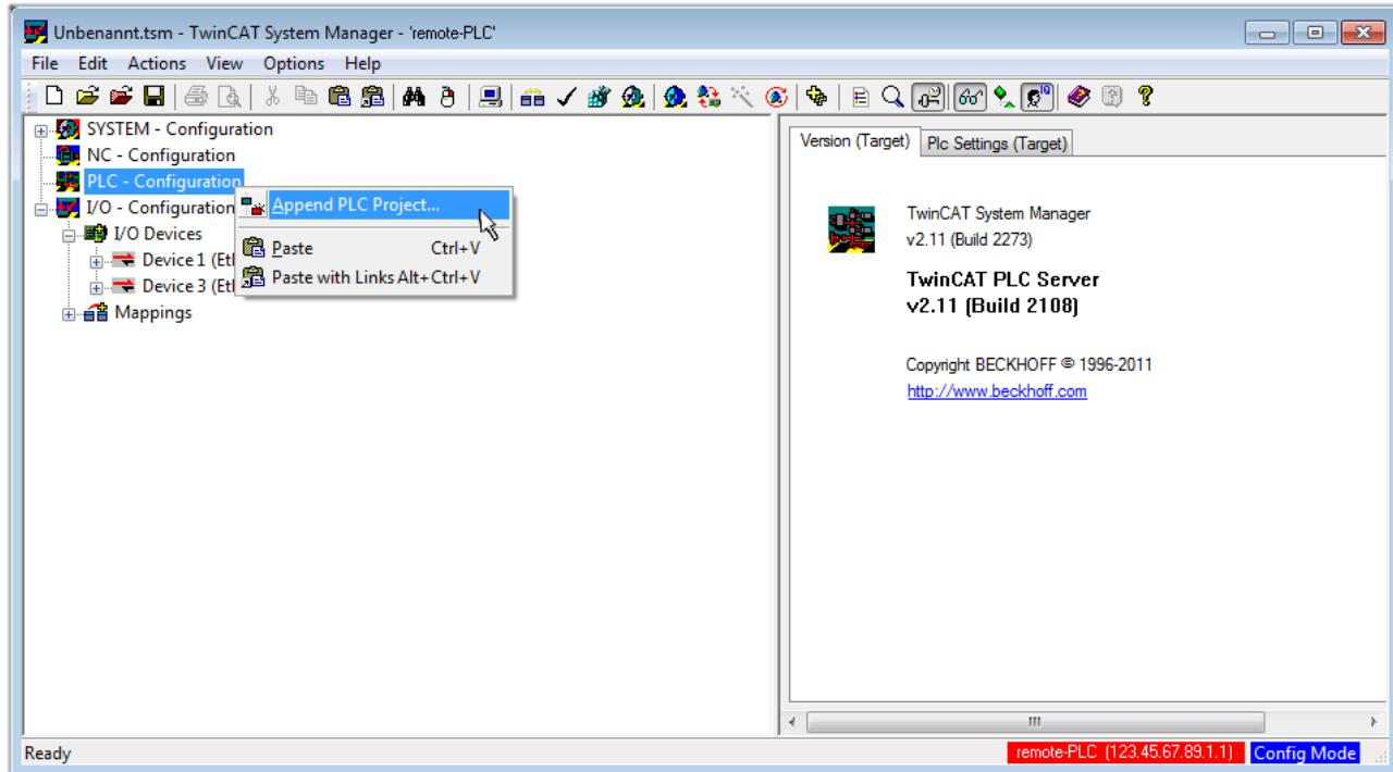
附图 43: 添加TwinCAT PLC控制项目
