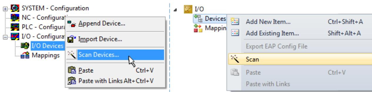
附图 101: 扫描设备 (左: TwinCAT 2; 右: TwinCAT 3)
