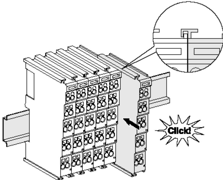
附图 16: 安装在安装轨道上
