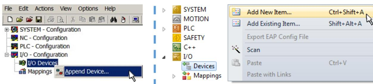
附图 90: 添加EtherCAT设备 (左: TwinCAT 2; 右: TwinCAT 3)
