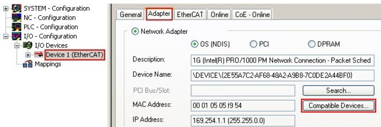
附图 77: EtherCAT设备属性 (TwinCAT 2) : 点击“适配器”选项卡的“兼容设备...”
