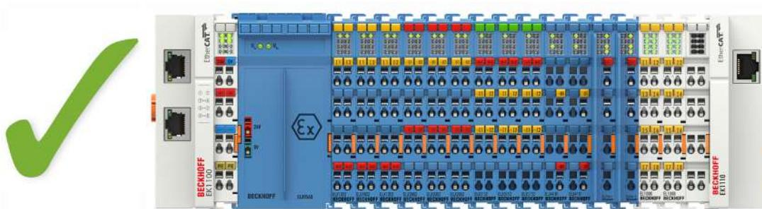
附图 7: 允许的安装 - 不属于 ELX 系列的端子模块被放置在 ELX 端子模块网段的前后。由 ELX 端子模块网段开头的 ELX9560 和 ELX 端子模块网段末端的两个 ELX9410 隔离。
