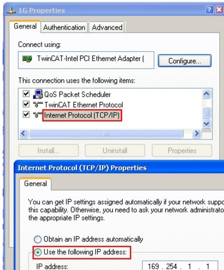
附图 81: 以太网端口的TCP/IP设置
