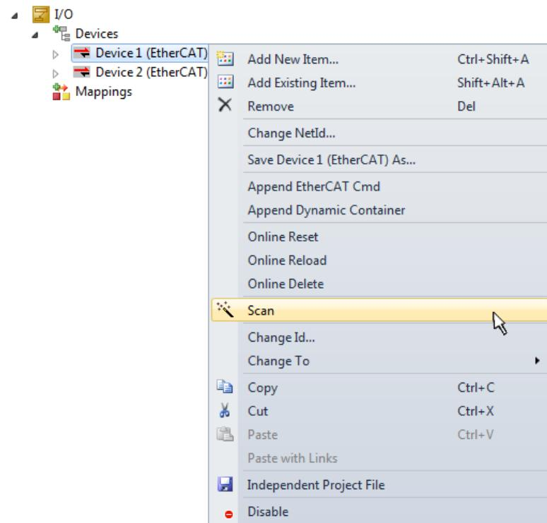
附图 59: 读取连接到设备的单个终端
