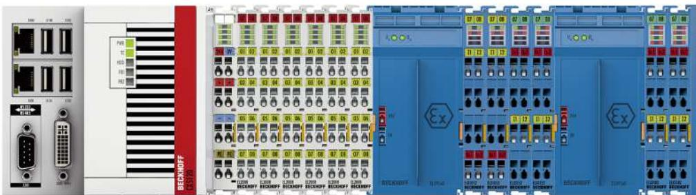
附图 13: 不允许的安装 - ELX 端子模块网段中的第二个 ELX9560 电源端子模块没有前端的 ELX9410。
