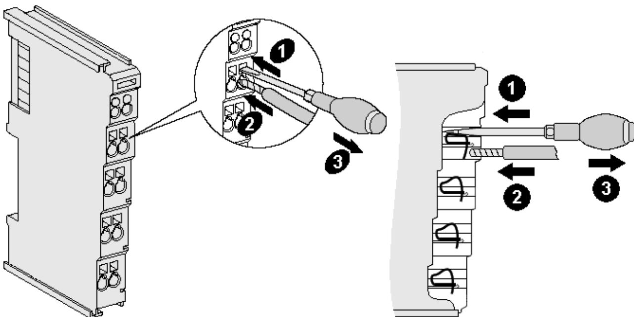
附图 20: 在一个接线点上连接电缆
