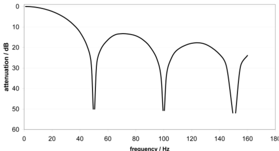
附图 144: 50 Hz 时的衰减曲线陷波滤波器
