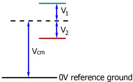
附图 26: 共模电压 ( $V_{cm}$ )
