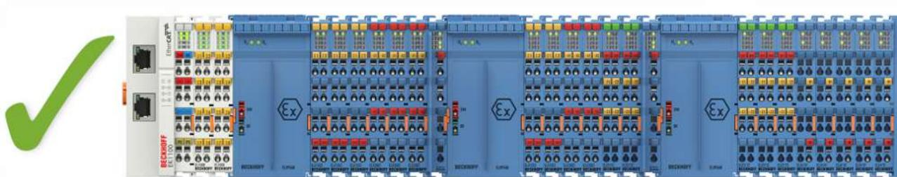
附图 9: 允许的安装 - 由 ELX9560 提供多个再次供电电源，在每种情况下都有一个前端的 ELX9410。
