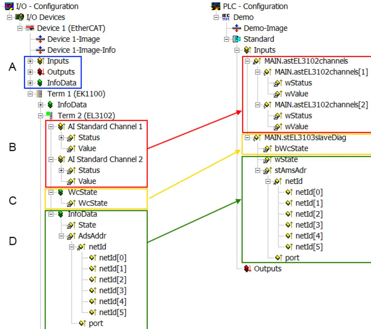
附图 132: PLC 中的基本 EtherCAT 从站诊断
