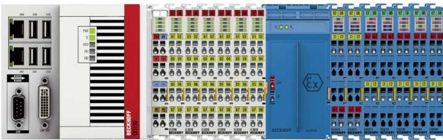
附图 14: 非法的安装 - 缺少 ELX9012 总线终端盖板。
