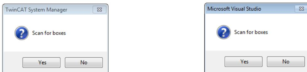
附图 107: 自动创建一个EtherCAT设备后的扫描查询（左：TwinCAT 2；右：TwinCAT 3）
