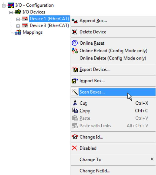
附图 40: 读取连接到设备的单个终端
