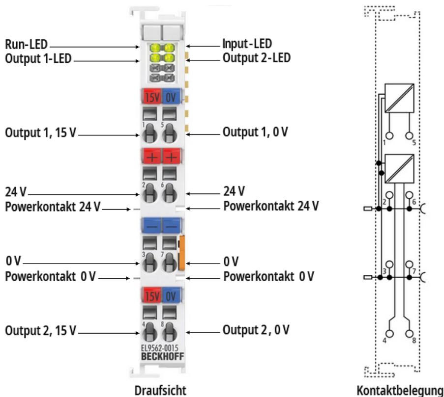
Abb. 19: EL9562-0015 - Anschlussbelegung und LED-Anzeigen
