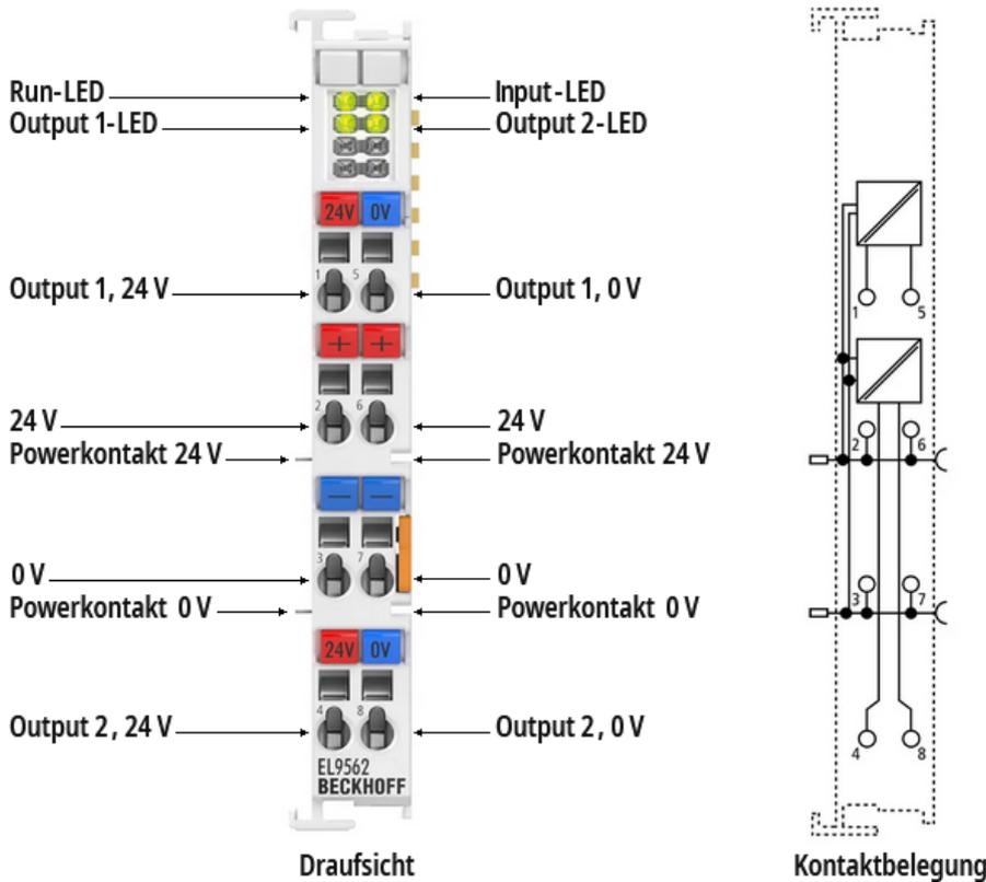
Abb. 18: EL9562 - Anschlussbelegung und LED-Anzeigen
