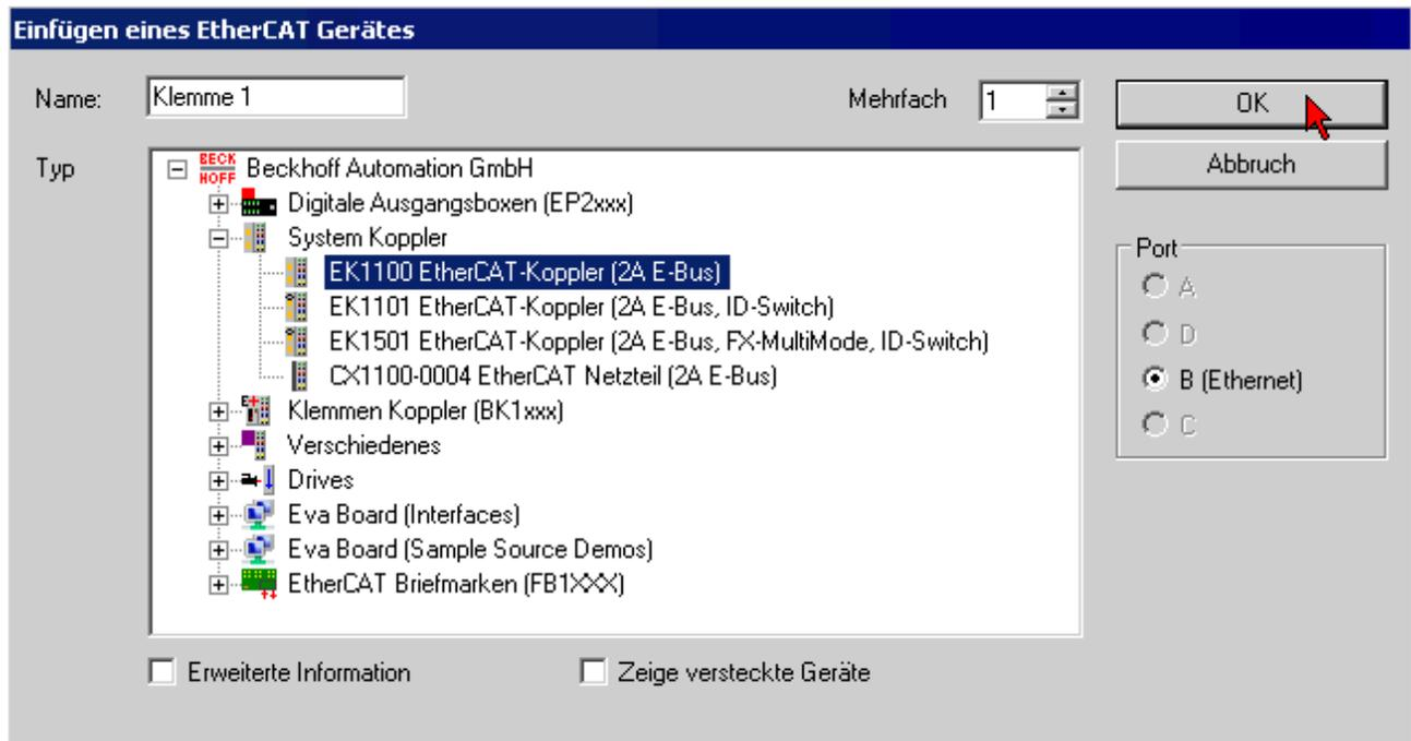
Abb. 24: Auswahl eines System-Kopplers (z. B. EK1100)
