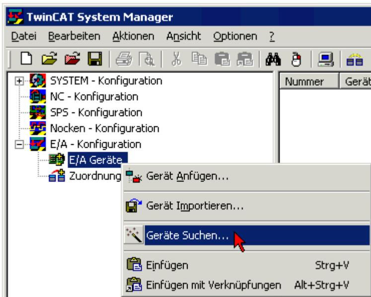
Abb. 20: Einscannen der EtherCAT Konfiguration (E/A-Geräte -> Rechte Maustaste -> Geräte suchen...)
