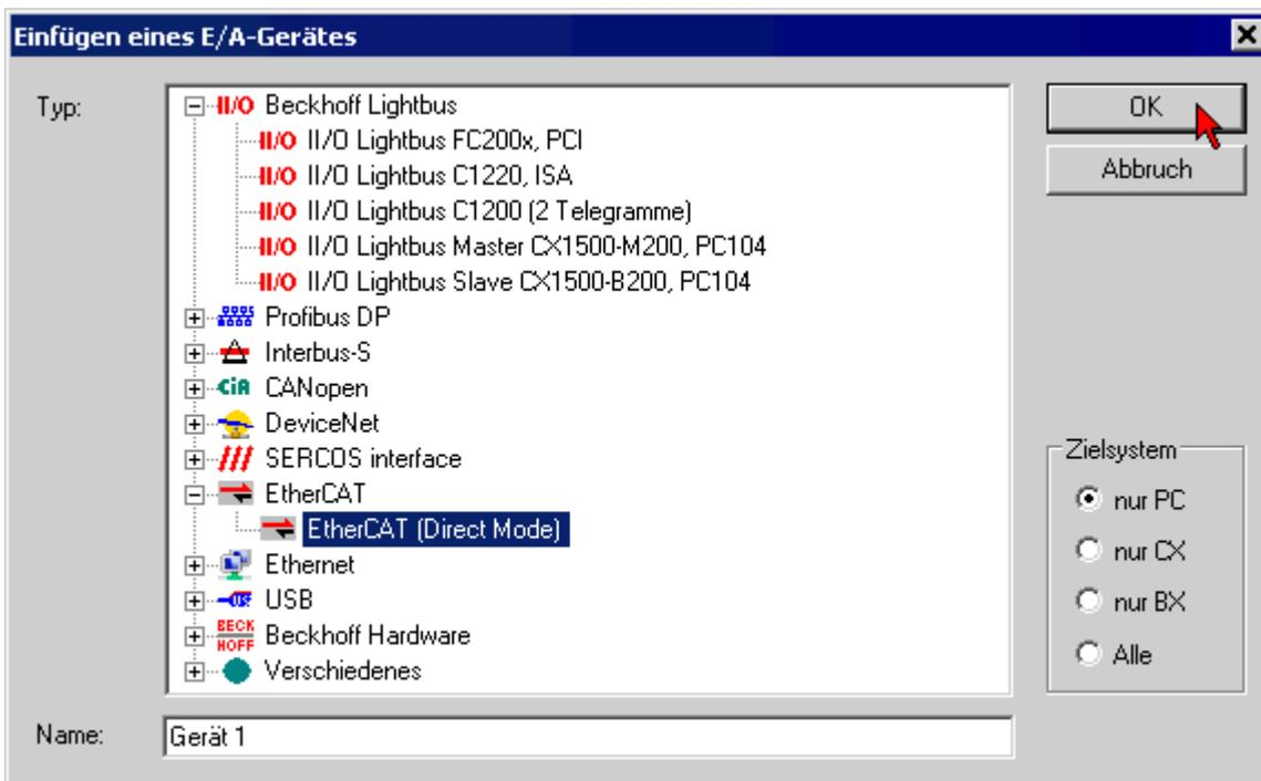
Abb. 22: Auswahl des Gerätes EtherCAT (Direct Mode)
