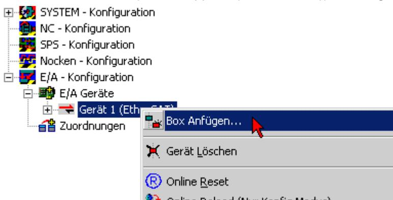
Abb. 23: Anfügen einer neuen Box (Gerät -> Rechte Maustaste -> Box anfügen...)
