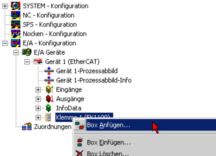
Abb. 25: Anfügen einer neuen Box (Gerät -> Rechte Maustaste -> Box anfügen...)
