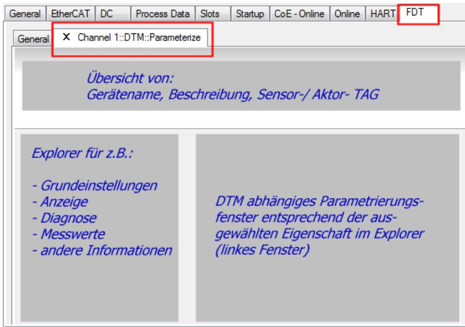
Abb. 21: Allgemeiner Aufbau eines DTM-Konfigurationsfensters innerhalb des Field Device Tools (FDT)
