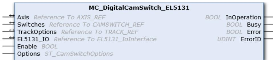
Abb. 178: Funktionsbaustein „MC\_DigitalCamSwitch\_EL5131“
