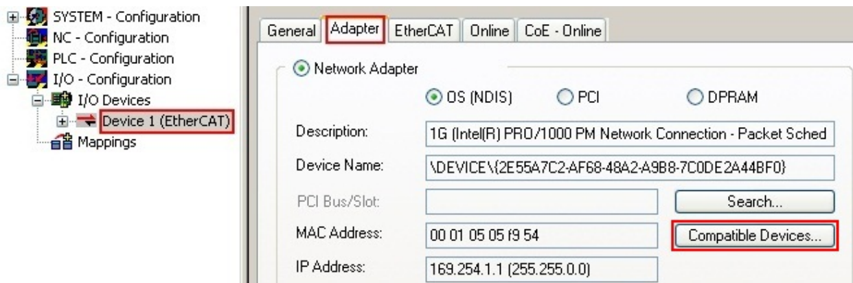
附图 97: EtherCAT 设备属性（TwinCAT 2）：点击“Adapter”选项卡的“Compatible Devices...”
