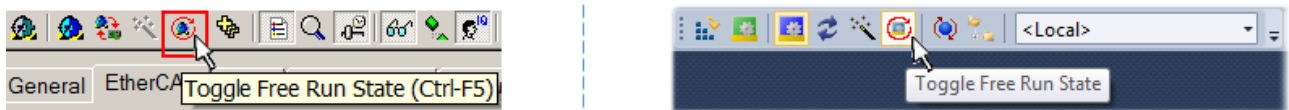
附图 133: TwinCAT 也可以通过一个按钮切换到这种状态 (左: TwinCAT 2; 右: TwinCAT 3)
