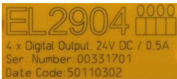
Abb. 7: EL2904 IP20 Safety Klemme mit Chargennummer/ DateCode 50110302 und eindeutiger Seriennummer 00331701
