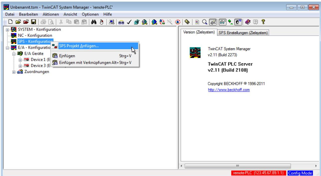
Abb. 36: Hinzufügen des Projektes des TwinCAT PLC Control
