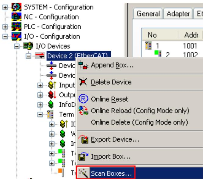
Abb. 140: Rechtsklick auf das EtherCAT-Gerät bewirkt das Scannen des unterlagerten Feldes
