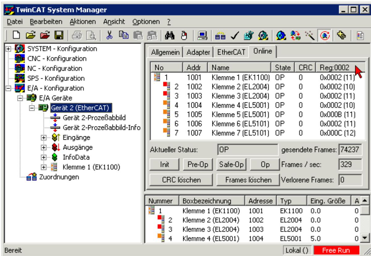
Abb. 147: Versionsbestimmung FPGA-Firmware
