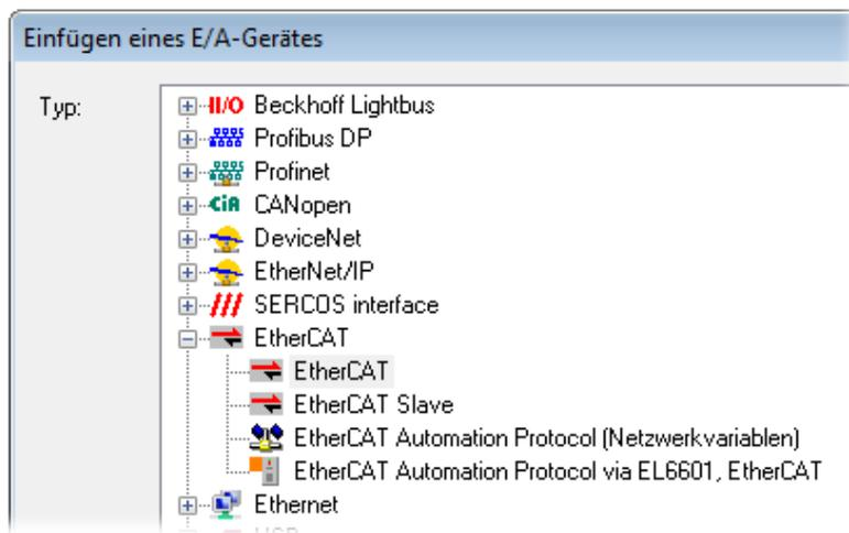
Abb. 85: Auswahl EtherCAT Anschluss (TwinCAT 2.11, TwinCAT 3)
