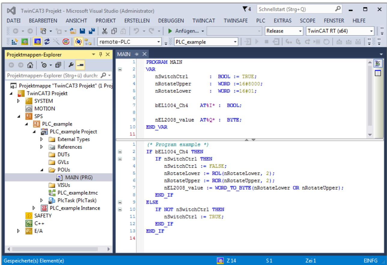
Abb. 56: Beispielprogramm mit Variablen nach einem Kompilervorgang (ohne Variablenanbindung)
