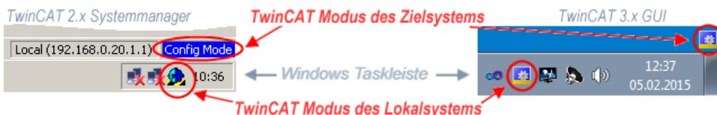
Abb. 94: Unterscheidung Lokalsystem/ Zielsystem (links: TwinCAT 2; rechts: TwinCAT 3)
