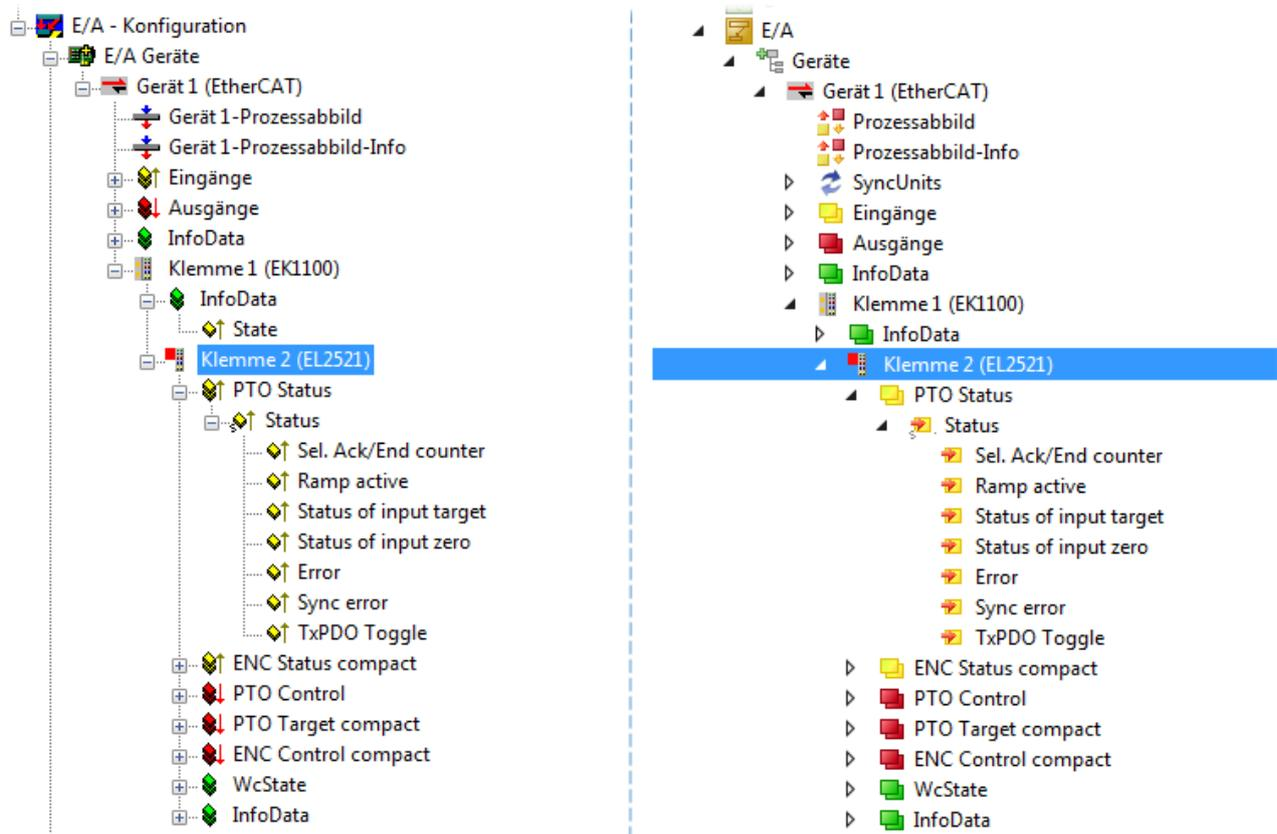
Abb. 93: EtherCAT Klemme im TwinCAT-Baum (links: TwinCAT 2; rechts: TwinCAT 3)
