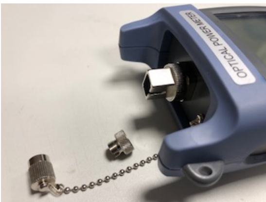
OPM mit aufgeschraubtem SC Adapter
