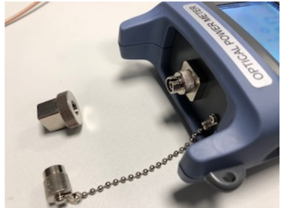
OPM mit aufgeschraubtem FC Adapter
