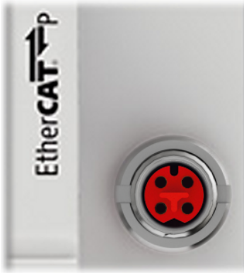
Abb. 24: M8 EtherCAT P-Anschluss
