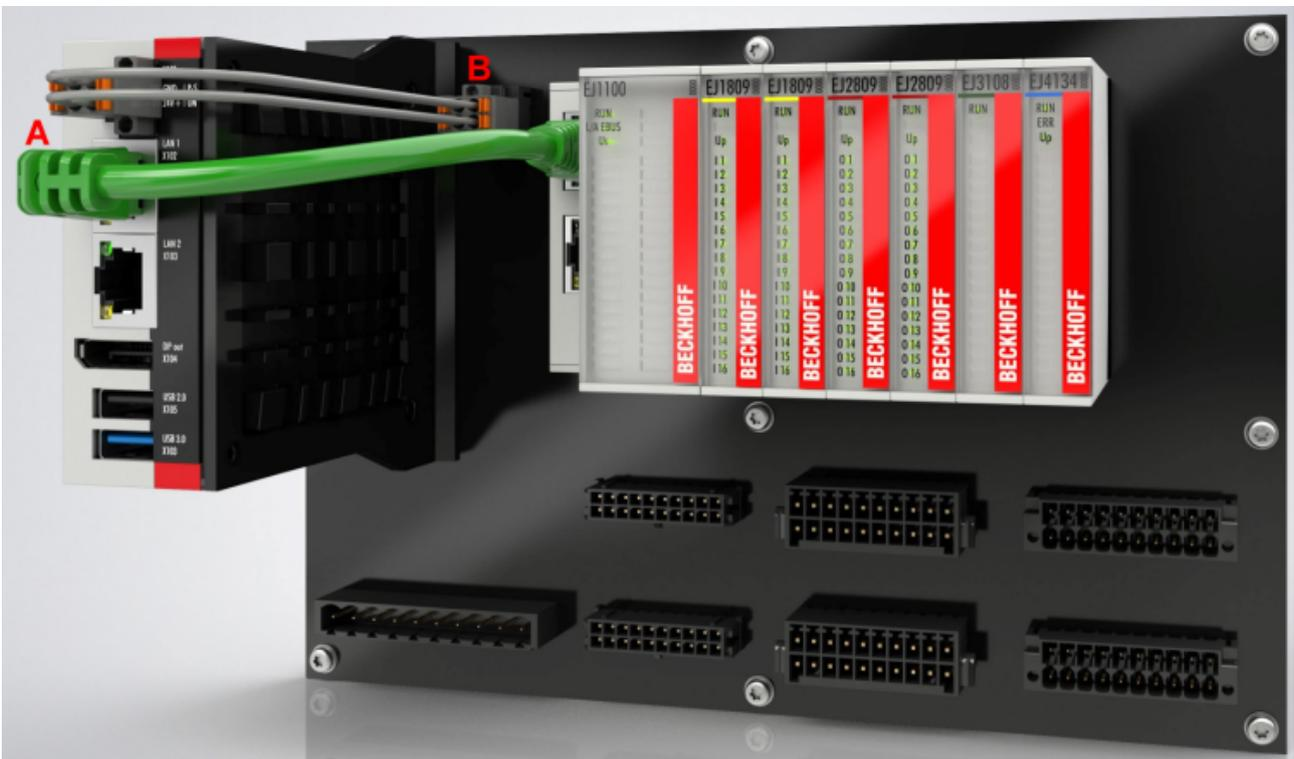
Abb. 26: Beispiel für die Anbindung des IPC C6015 an ein EJ-System
