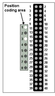
Fig. 19: Pin coding; sample: digital input modules
