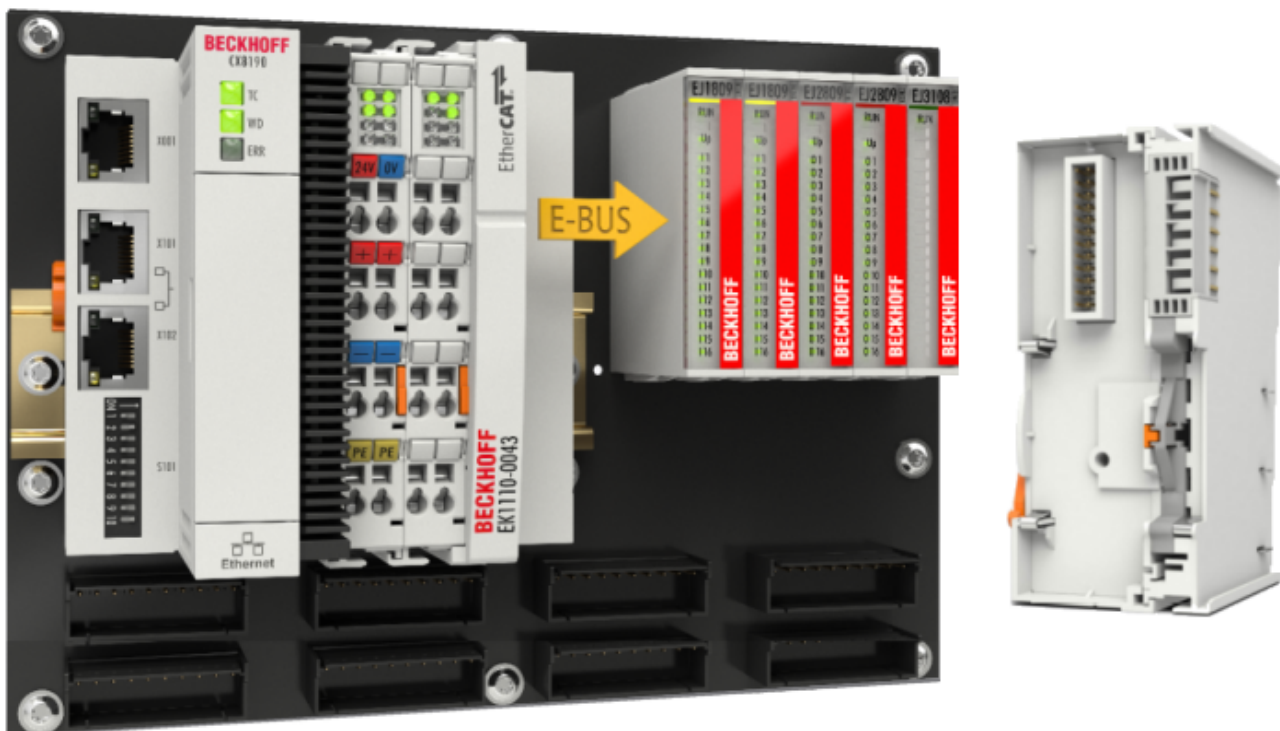
Abb. 30: Beispiel Leiterkarte mit Embedded PC, EK1110-0043 und EJxxxx, Rückansicht EK1110-0043
