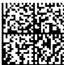
Abb. 4: Beispiel-DMC 1P072222SBTNk4p562d71KEL1809 Q1 51S678294
