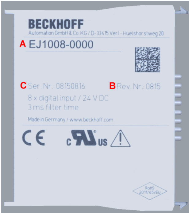
Abb. 2: Bestellbezeichnung (A), Revisionsnummer (B) und Seriennummer (C) am Beispiel EJ1008
