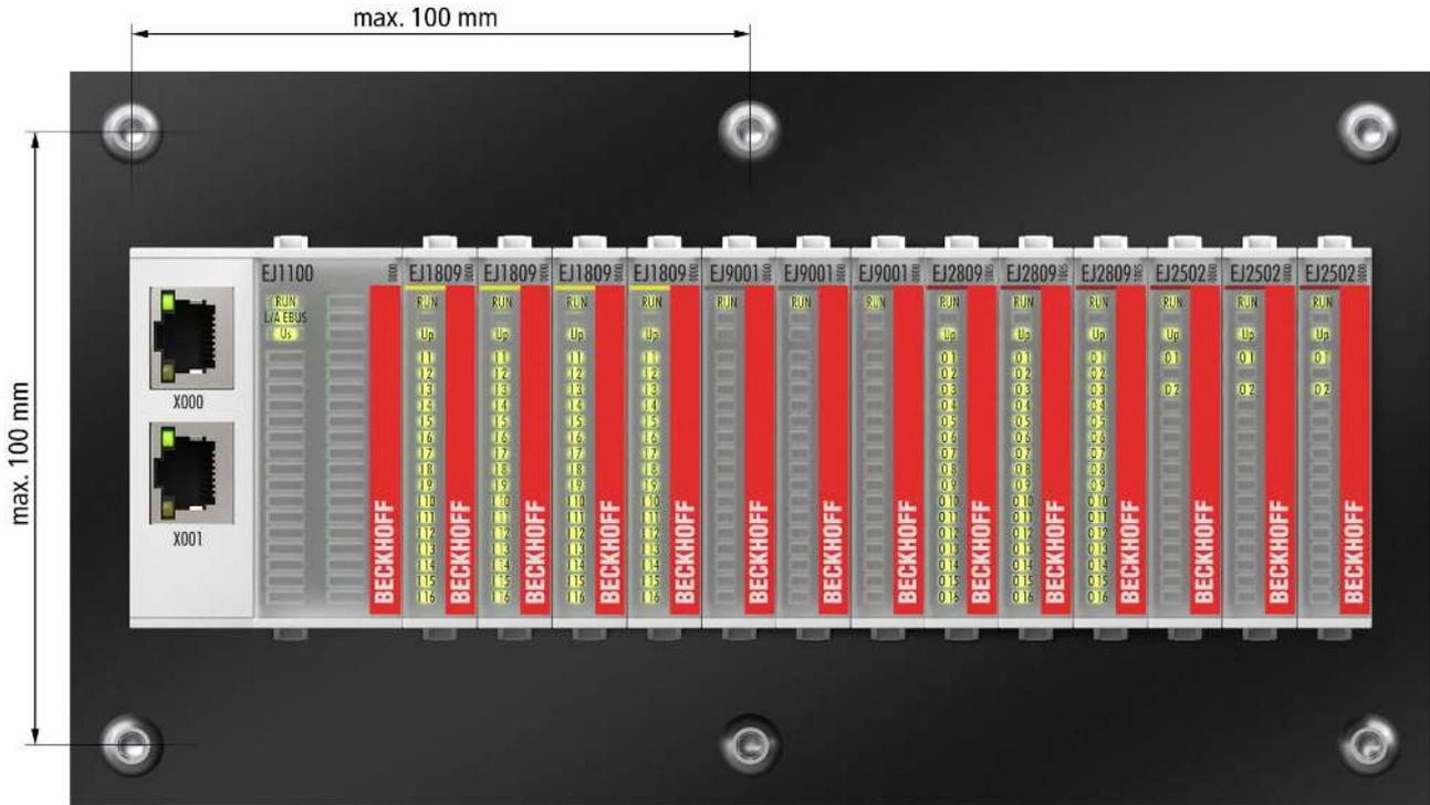
Abb. 1: Maximal Abstände zwischen den Montagebohrungen der Leiterplatte
