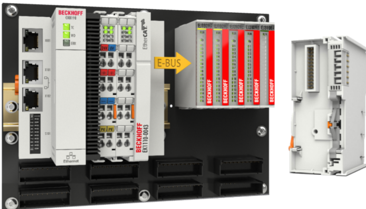
Abb. 10: Leiterkarte mit Embedded PC, EK1110-0043 und EJxxxx, Rückansicht EK1110-0043
