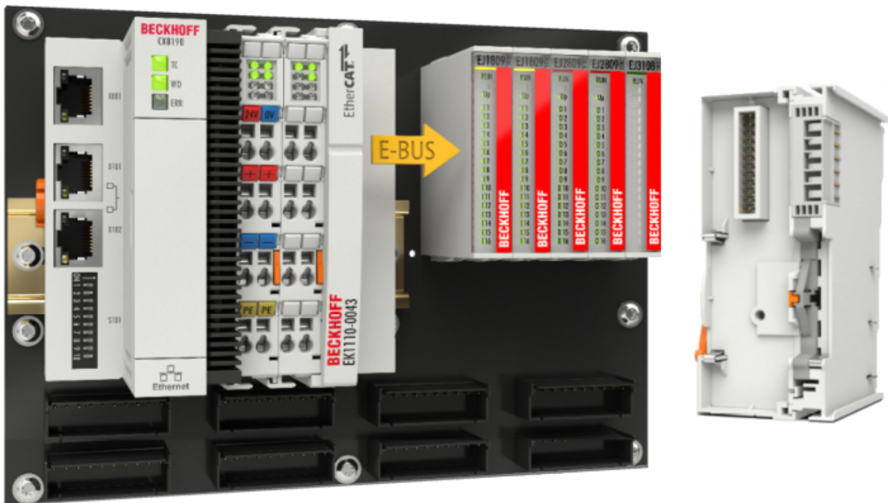
Abb. 27: Beispiel Leiterkarte mit Embedded PC, EK1110-0043 und EJxxxx, Rückansicht EK1110-0043
