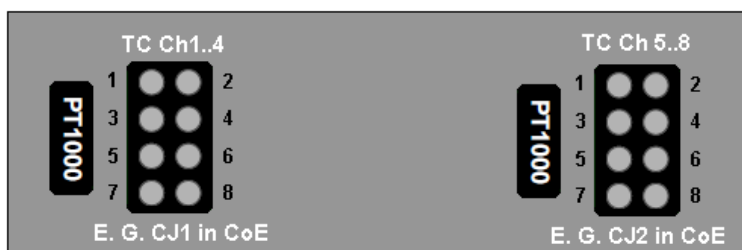
Abb. 23: Routing der TCs zu zwei verschiedenen TC-Steckern am Beispiel EJ3318
