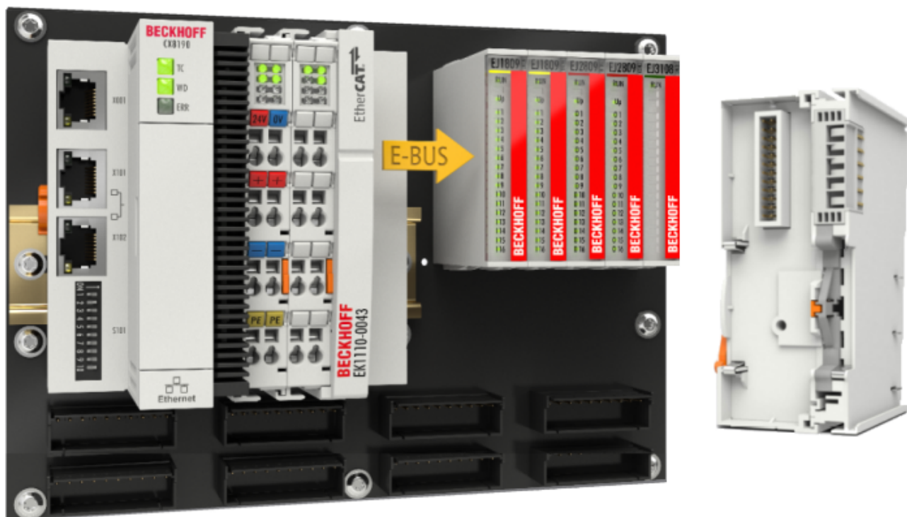
Abb. 39: Beispiel Leiterkarte mit Embedded PC, EK1110-0043 und EJxxxx, Rückansicht EK1110-0043
