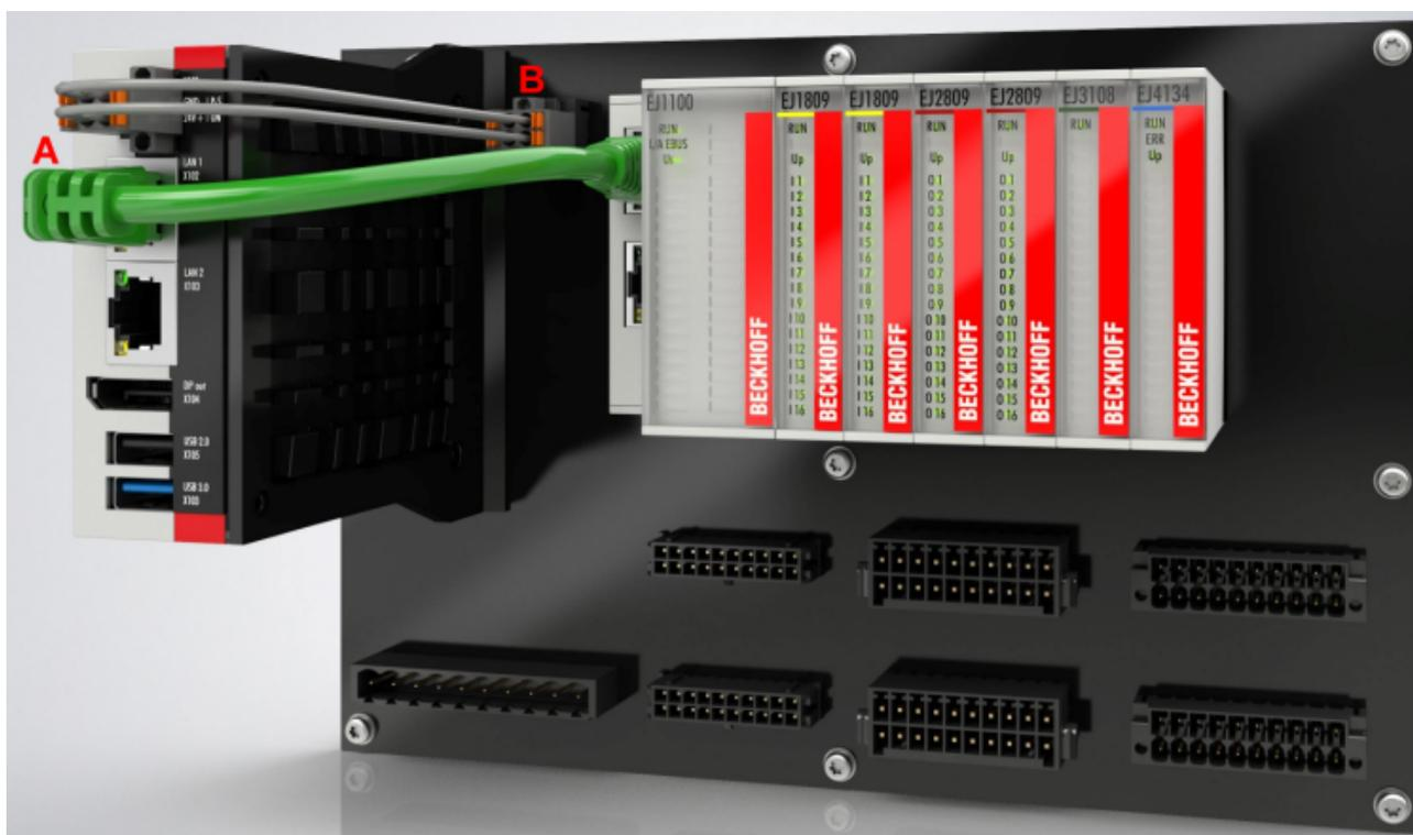
Abb. 29: Beispiel für die Anbindung des IPC C6015 an ein EJ-System
