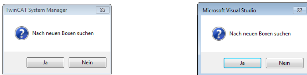
Abb. 57: Scan-Abfrage nach dem automatischen Anlegen eines EtherCAT Gerätes (links: TwinCAT 2; rechts TwinCAT 3)
