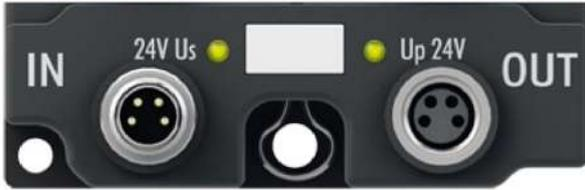
Abb. 11: Status-LEDs der Versorgungsspannungen
