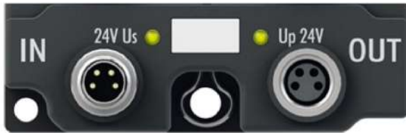
Abb. 11: Status-LEDs der Versorgungsspannungen
