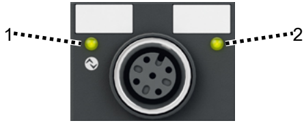
Abb. 6: Status-LEDs eines IO-Link Ports
