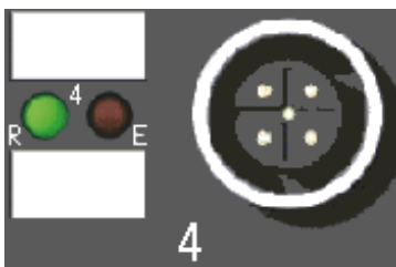
Abb. 4: Status- und Diagnose-LED am M12-Steckverbinder
