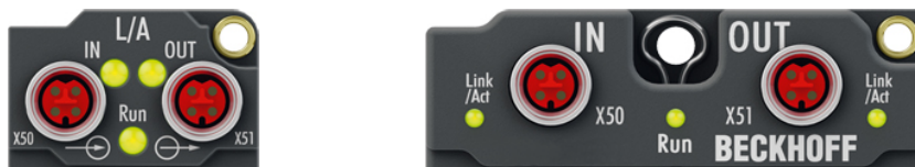
Abb. 2: Steckverbinder für EtherCAT P
