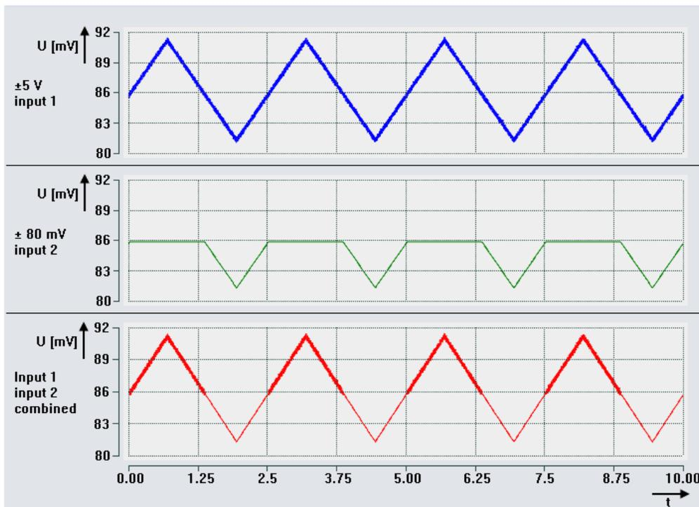
Abb. 36: Kombination zweier Kanäle der ELM3602-0002: Zuführung einer Dreiecksspannung im positiven Übergangsbereich
