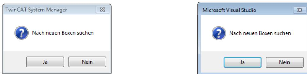
Abb. 128: Scan-Abfrage nach automatischem Anlegen eines EtherCAT-Gerätes (links: TC2; rechts TC3)
