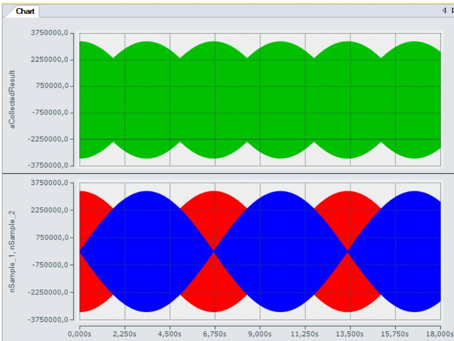
Abb. 30: Oversampling 20 KSps mit 2 x EL3751 mit Eingangssignalen (unten) und Ergebnissignal (oben)
