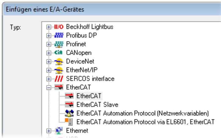
Abb. 112: Auswahl EtherCAT Anschluss (TwinCAT 2.11, TwinCAT 3)
