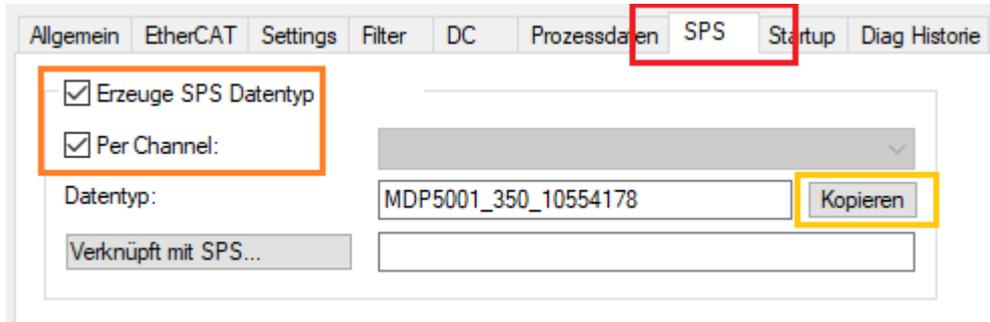
Abb. 38: Erstellung der PDO Variablen (TwinCAT-Version >= V3.1.4024.0)
