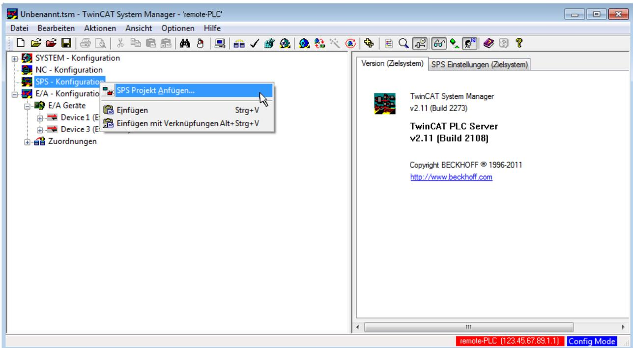
Abb. 63: Hinzufügen des Projektes des TwinCAT PLC Control
