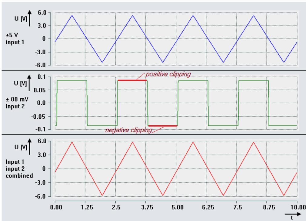
Abb. 35: Kombination zweier Kanäle der ELM3602-0002 mit ±5 V und ±80 mV Messbereich
