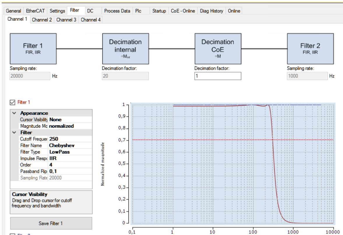
Abb. 20: TwinCAT FilterControl, eingebettet in den Konfigurationsdialog einer EPP35xx/ ERP35xx-Box
