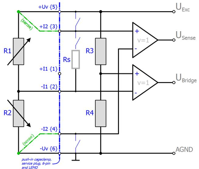
$R_{3/4}$  sind die internen schaltbaren Ergänzungswiderstände der Box. Sie sind mit einigen  $k\Omega$  hochohmig im Vergleich zu  $R_{1/2}$  und belasten die interne Speisung somit nicht wesentlich.
