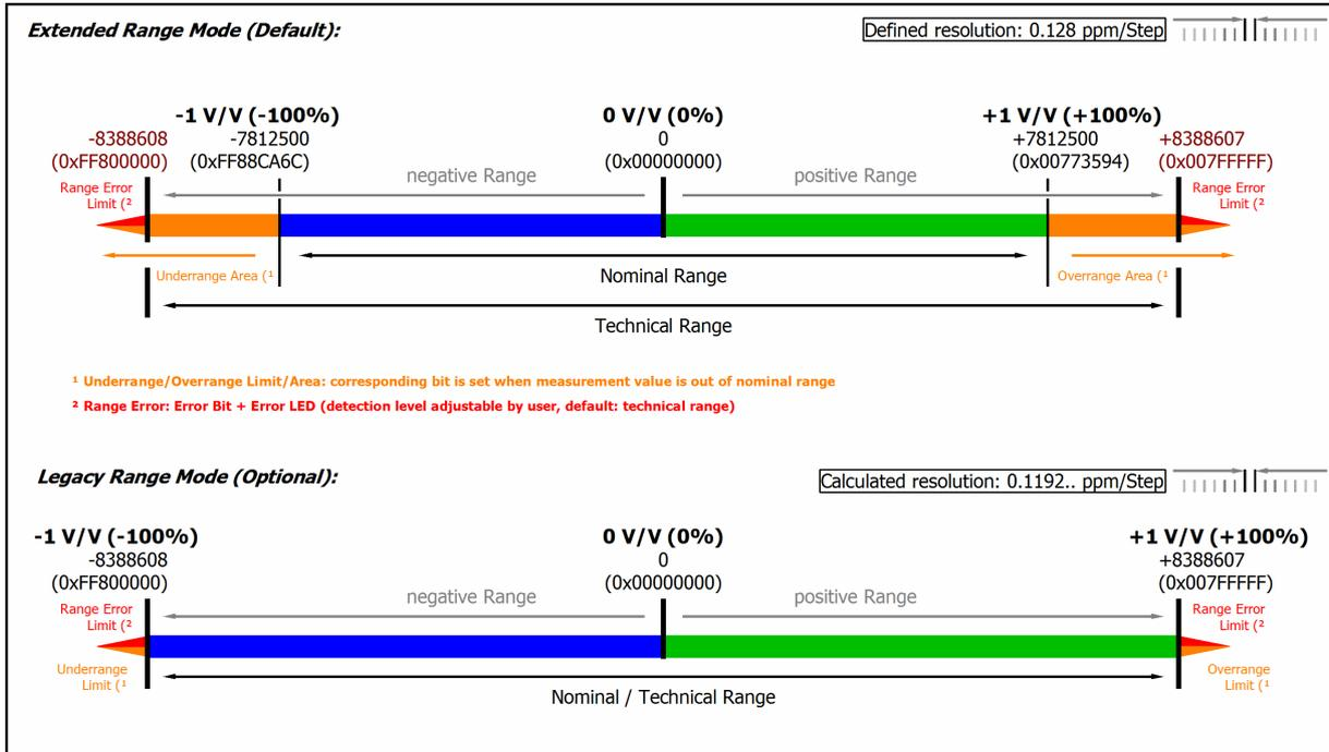
Abb. 14: Darstellung Potentiometer-Messbereich
