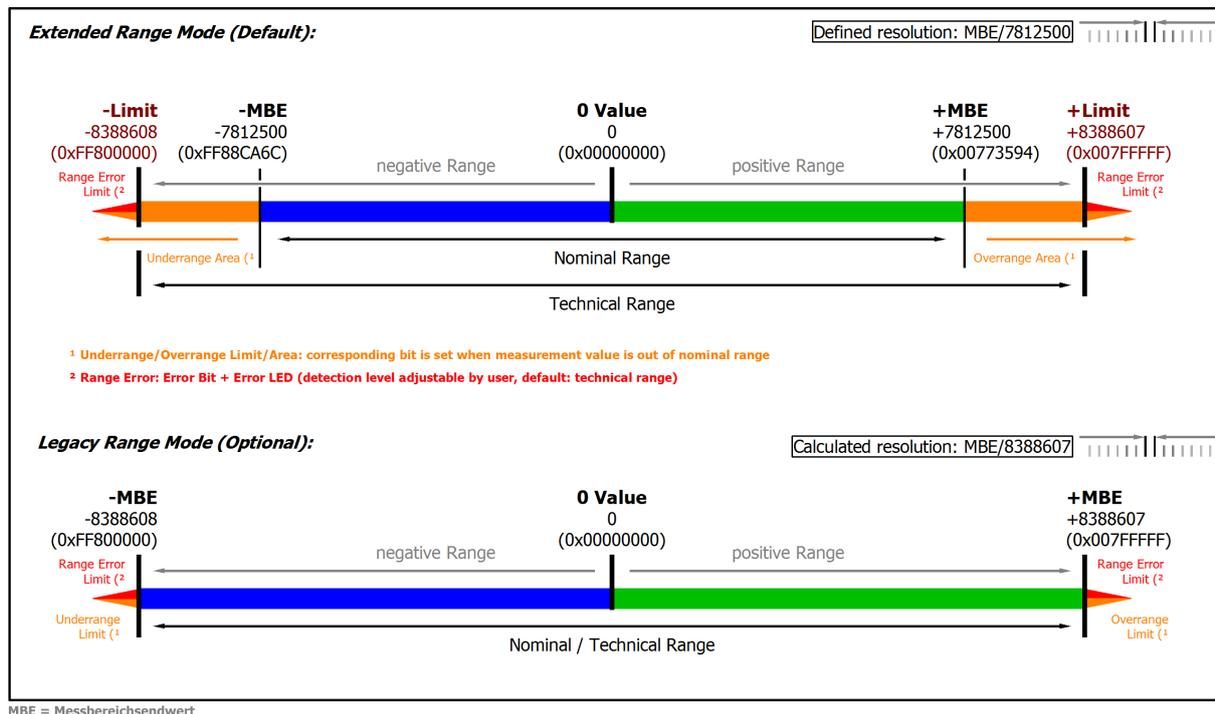
Abb. 17: Basis Bereich eines Prozessdatenwertes
