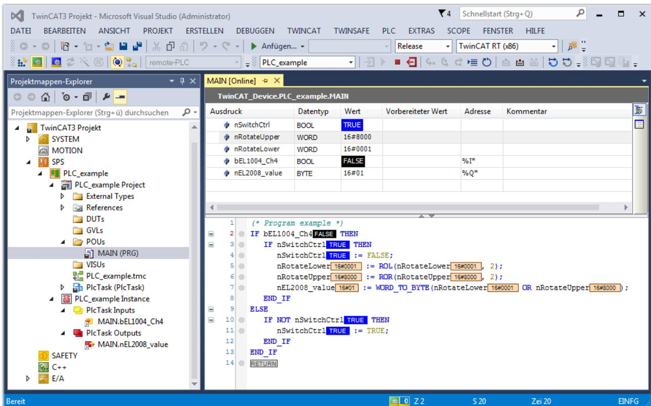
Abb. 93: TwinCAT 3 Entwicklungsumgebung (VS Shell): Logged-in, nach erfolgten Programmstart
