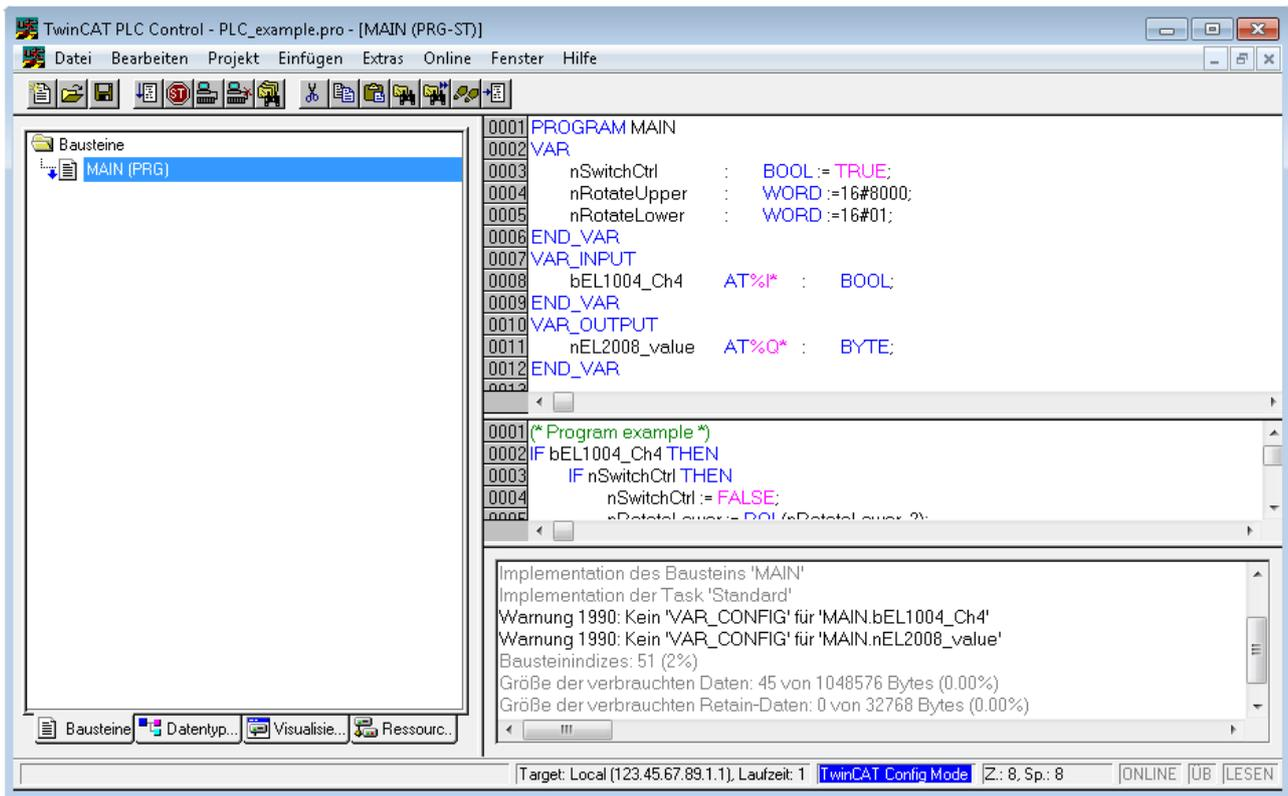
Abb. 62: Beispielprogramm mit Variablen nach einem Kompilervorgang (ohne Variablenanbindung)
