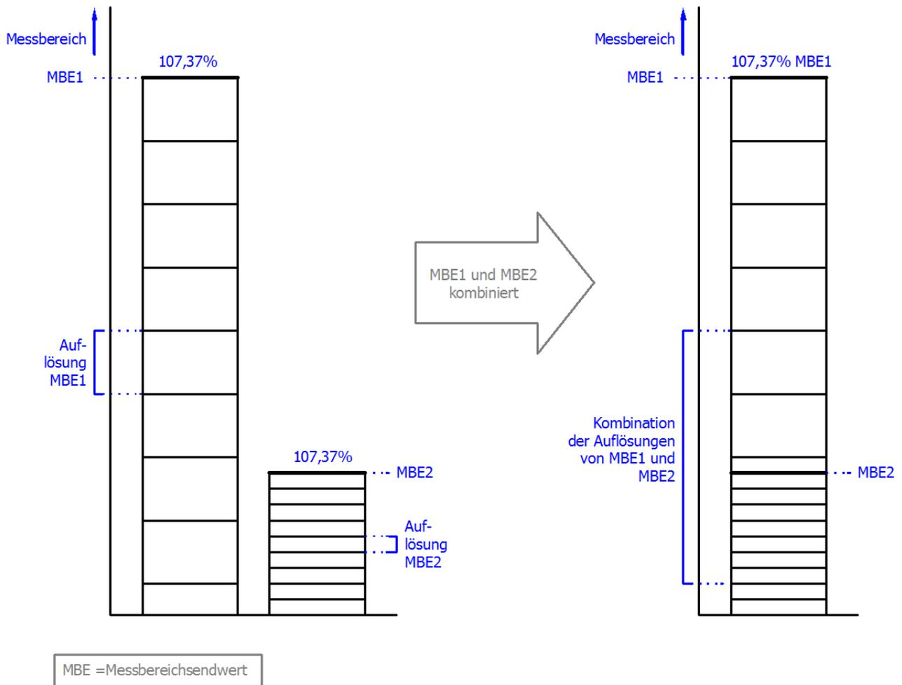
Abb. 33: Prinzip der Kombination zweier Messkanäle mit MBE1 und MBE2
