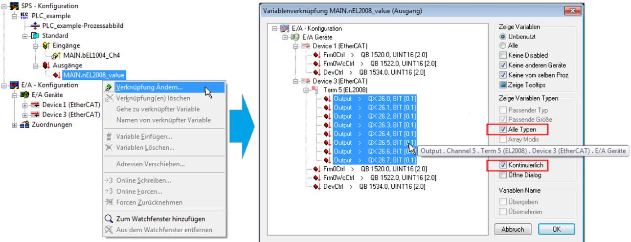
Abb. 67: Auswahl von mehreren PDO gleichzeitig: Aktivierung von „Kontinuierlich“ und „Alle Typen“
