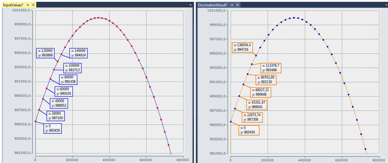
Abb. 32: Dezimierung von 20 µs (links) auf 22,675.. µs (rechts) mit ELM3602
