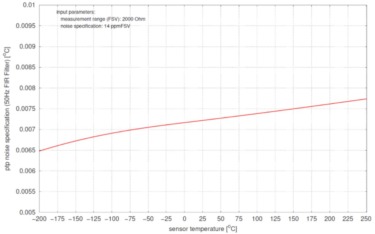
Abb. 13: Diagramm Rauschen  $F_{\text{Noise, PtP}}$  in Abhängigkeit zur Sensortemperatur
