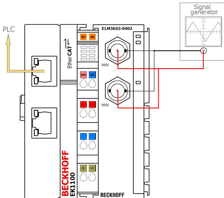
Abb. 34: Möglicher Aufbau für das Beispielprogramm "Messbereichskombination"
