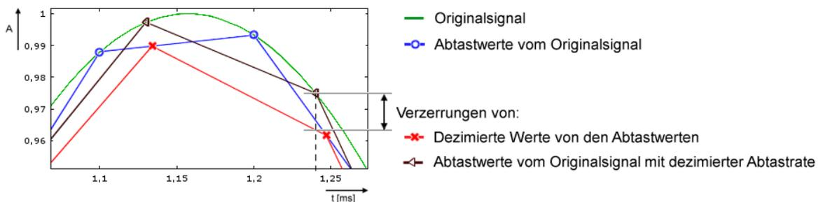
Im Frequenzspektrum wird dies z.B. durch eine Berechnung mit 20 Hz Sinussignal, abgetastet mit 500 Sps und dezimiert auf 441 Sps wie folgt anschaulich:
