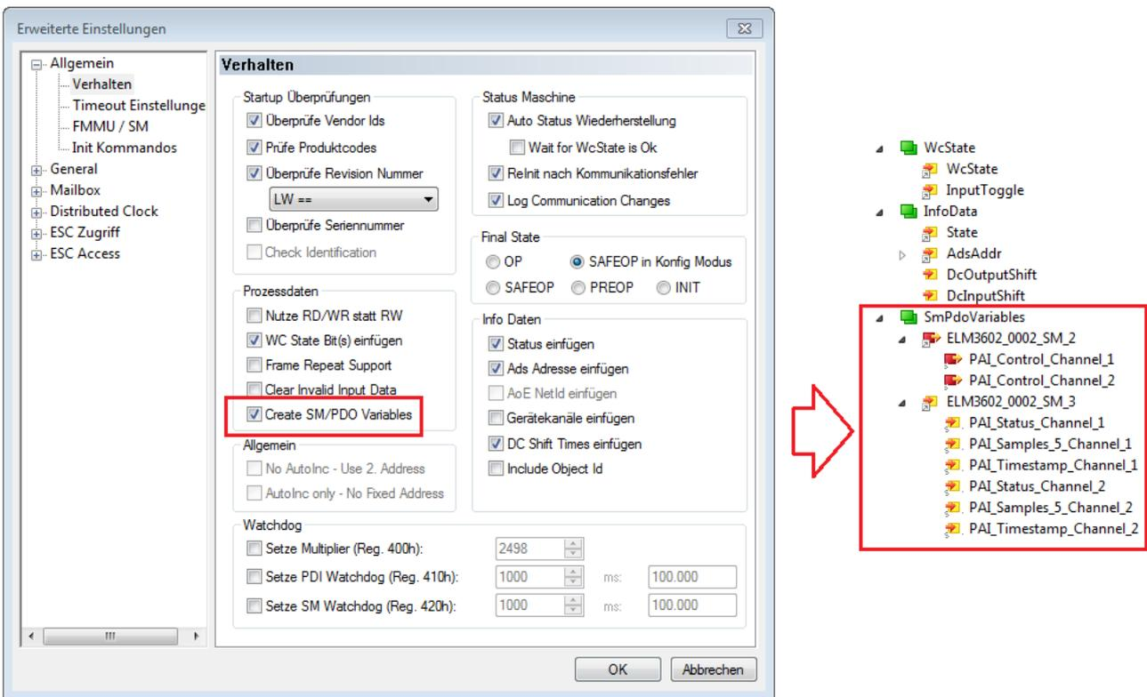
Abb. 39: Erstellung der SmPdoVariables (TwinCAT-Version >= V3.1.4022.30)
