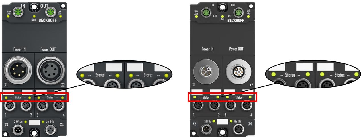
Die Status-Bits befinden sich in den Prozessdaten. Sie melden Stati, Warnungen und Fehler für das gesamte Gerät.
