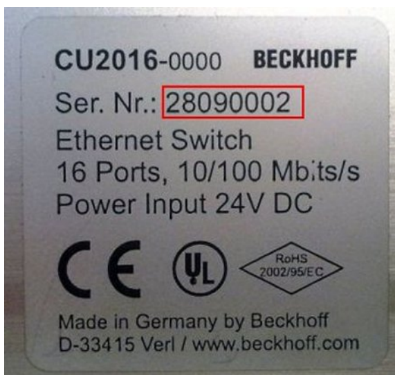
Abb. 21: CU2016 Switch mit Seriennummer/ Chargennummer
