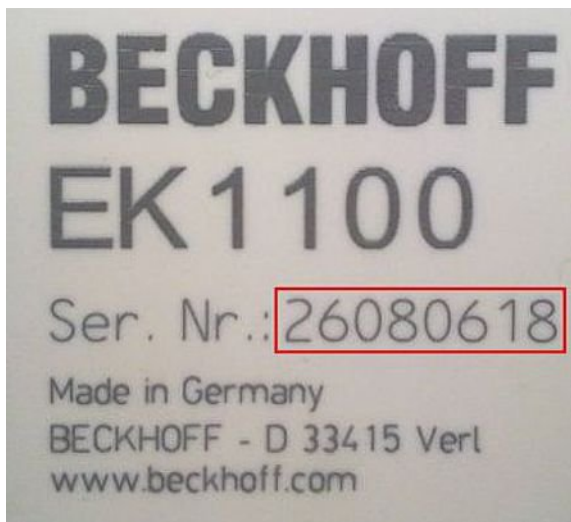
Abb. 20: EK1100 EtherCAT Koppler, Standard IP20-IO-Gerät mit Seriennummer/ Chargennummer
