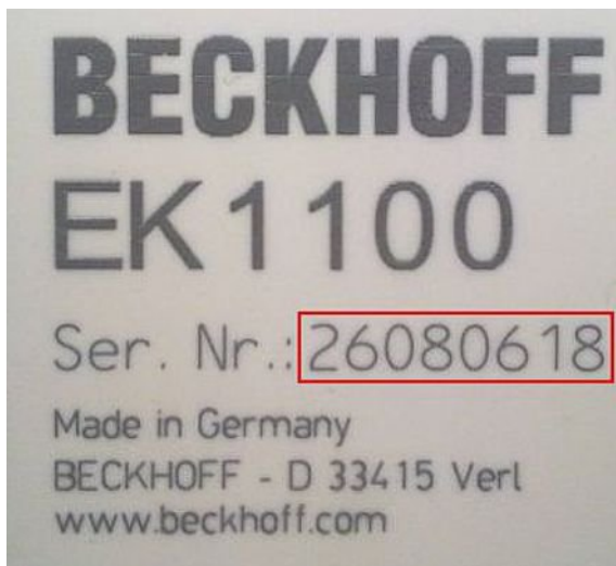
図 24: シリアル/バッチ番号が記載されたEK1100 EtherCATケーブル、標準IP20 I/Oデバイス
